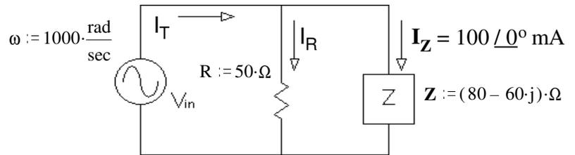
b) Find  $I_T$  in polar form.  $I_R := \frac{V_{in}}{R} = \frac{10 \cdot \text{V}}{50 \cdot \Omega} \angle -36.9^\circ = \frac{10 \cdot \text{V}}{50 \cdot \Omega} \cdot \cos(-36.9 \cdot \text{deg}) + j \cdot \frac{10 \cdot \text{V}}{50 \cdot \Omega} \cdot \sin(-36.9 \cdot \text{deg}) = 160 - 120j \cdot \text{mA}$
