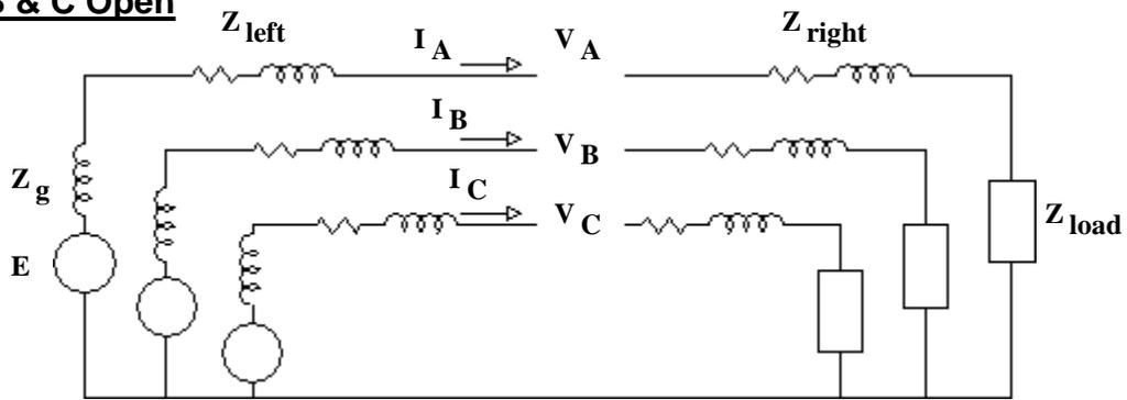
$$\begin{bmatrix} V_{A0} \\ V_{A1} \\ V_{A2} \end{bmatrix} = \frac{1}{3} \begin{bmatrix} 1 & 1 & 1 \\ 1 & a & a^2 \\ 1 & a^2 & a \end{bmatrix} \begin{bmatrix} I_{A0} \\ I_{A1} \\ I_{A2} \end{bmatrix}$$
