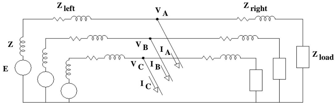
$$\begin{bmatrix} I_{A0} \\ I_{A1} \\ I_{A2} \end{bmatrix} = \frac{1}{3} \begin{bmatrix} 1 \\ 1 \\ 1 \end{bmatrix} = \frac{1}{3} \begin{bmatrix} 1 \\ 1 \\ 1 \end{bmatrix} = \frac{1}{3} \begin{bmatrix} 1 & 1 & 1 \\ 1 & a & a^2 \\ 1 & a^2 & a \end{bmatrix} \begin{bmatrix} I_A \\ I_B \\ I_C \end{bmatrix}$$
