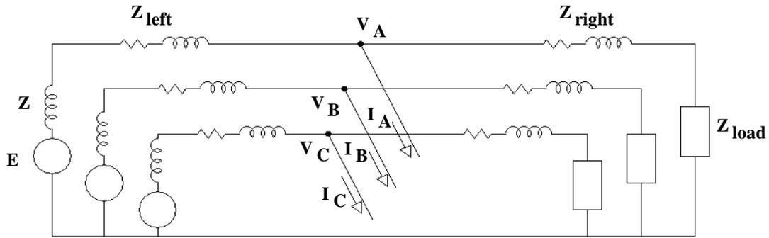
$$\begin{bmatrix} I_{A0} \\ I_{A1} \\ I_{A2} \end{bmatrix} = \begin{bmatrix} 3 \\ 3 \\ 3 \end{bmatrix} = \frac{1}{3} \cdot \begin{bmatrix} 1 & 1 & 1 \\ 1 & a & a^2 \\ 1 & a^2 & a \end{bmatrix} \cdot \begin{bmatrix} I_A \\ I_B \\ I_C \end{bmatrix}$$
