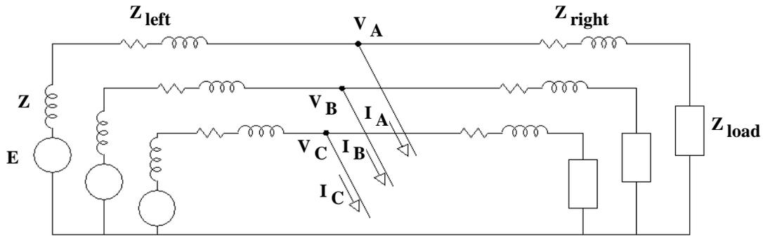
$$\begin{bmatrix} I_{A0} \\ I_{A1} \\ I_{A2} \end{bmatrix} = \frac{1}{3} \begin{bmatrix} 1 \\ 1 \\ 1 \end{bmatrix} = \frac{1}{3} \begin{bmatrix} 1 & 1 & 1 \\ 1 & a & a^2 \\ 1 & a^2 & a \end{bmatrix} \begin{bmatrix} I_A \\ I_B \\ I_C \end{bmatrix}$$
