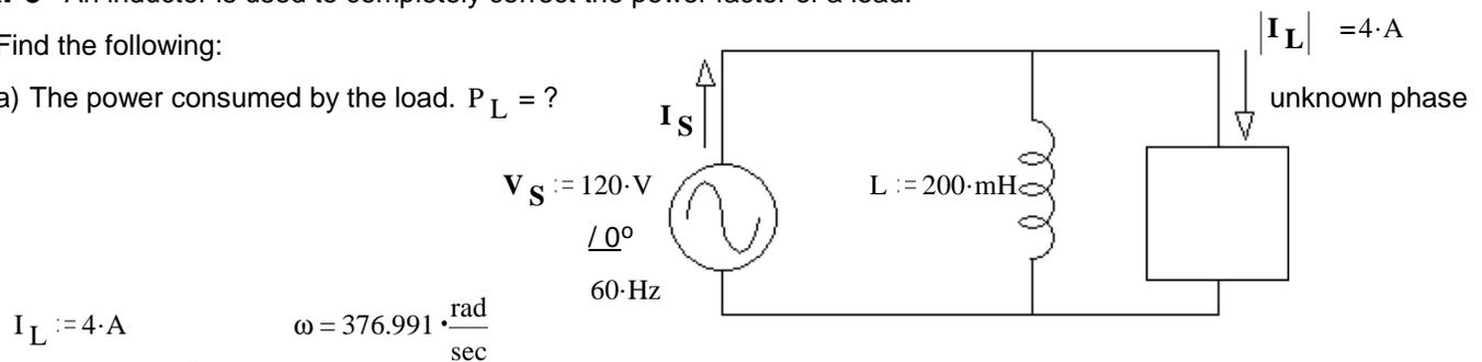
$$I_L := 4 \cdot \text{A} \quad \omega = 376.991 \cdot \frac{\text{rad}}{\text{sec}}$$
