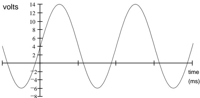
$$V_{DC} := \frac{14 \cdot V + -6 \cdot V}{2} \quad V_{DC} = 4 \cdot V$$
