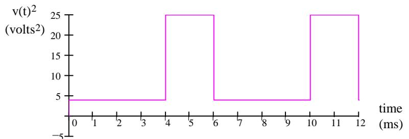
$V_{RMS} := \sqrt{11 \cdot V^2}$        $V_{RMS} = 3.32 \cdot V$
