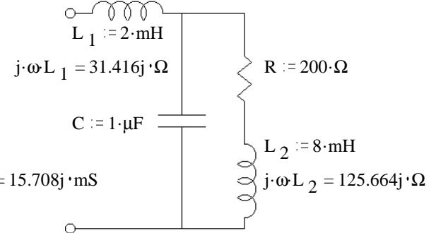
$$Z_{eq} = j\omega L_1 + \frac{1}{\frac{1}{R + j\omega L_2} + j\omega C} = 31.416 \cdot j \cdot \Omega + \frac{1}{\frac{1}{(200 + 125.664 \cdot j) \cdot \Omega} + 15.708 \cdot j \cdot \text{mS}}$$
