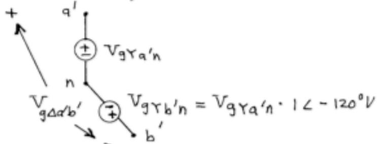
$$V_{g\Delta a'b'} = V_{gY a'n} - V_{gY b'n}$$
