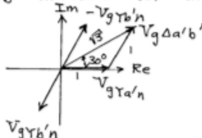
$$V_{g\Delta a'b'} = V_{gY a'n} \cdot \sqrt{3} \angle 30^\circ$$
