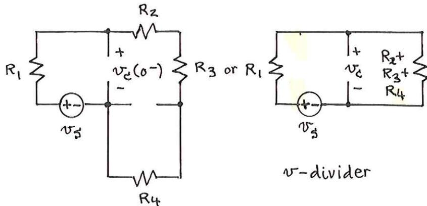
Using  $v$ -divider:  $v_C(0^-) = v_s \frac{R_2 + R_3 + R_4}{R_1 + R_2 + R_3 + R_4}$
