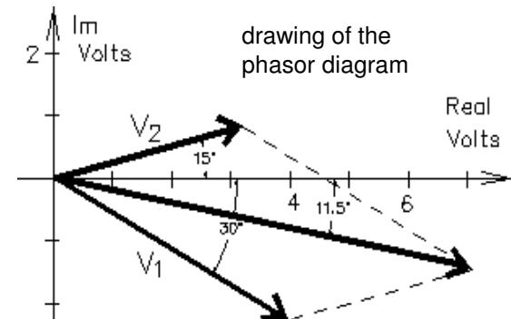
2. Two sinusoidal voltages:  $v_1(t) = 5 \cdot V \cdot \cos(\omega \cdot t + 36.87^\circ)$  and  $v_2(t) = 3.162 \cdot V \cdot \cos(\omega \cdot t - 18.44^\circ)$
