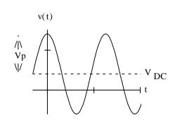
$$= \sqrt{\frac{1}{T}} \cdot \int_{0}^{T} \left[ \left( V_{p} \cdot \cos(\omega \cdot t) \right)^{2} + 2 \cdot \left( V_{p} \cdot \cos(\omega \cdot t) \right) \cdot V_{DC} + V_{DC}^{2} \right] dt$$
