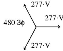
Apparent Power:  $|S_{3\phi}| = 3 \cdot V_{LN} \cdot I_L = 3 \cdot V_{LL} \cdot I_{LL} = \sqrt{3} \cdot V_{LL} \cdot I_L$
