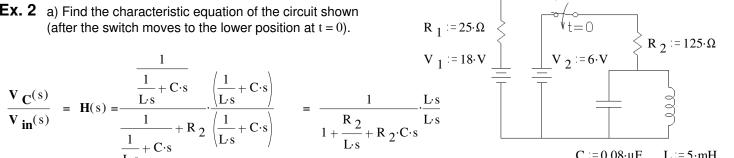
$$= \frac{\frac{1}{R_2 \cdot C \cdot L}}{\frac{1}{R_2 \cdot C \cdot L} \cdot s^2} \cdot \frac{\frac{1}{R_2 \cdot C \cdot L}}{\frac{1}{R_2 \cdot C \cdot L}} = \frac{\frac{1}{R_2 \cdot C} \cdot s}{\frac{1}{R_2 \cdot C} \cdot s + \frac{1}{L \cdot C} + s^2}$$
