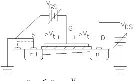
$$v_{DS} < v_{GS} - V_{t}$$
