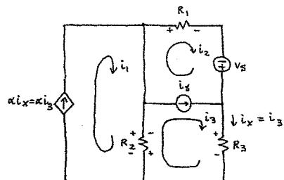
$$i_2, i_3 \text{ loop: } -i_3 R_2 + i_1 R_2 - i_2 R_1 - i_3 R_3 = 0V$$
