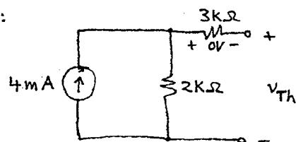
$$V_{Th} = 4\text{mA} \cdot 2\text{k}\Omega = 8\text{V}$$
