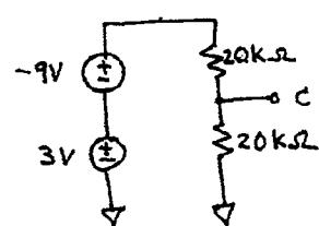
$$V_{Th} = (3V - 9V) \frac{20k\Omega}{20k\Omega + 20k\Omega} = -6V \cdot \frac{1}{2} = -3V$$
