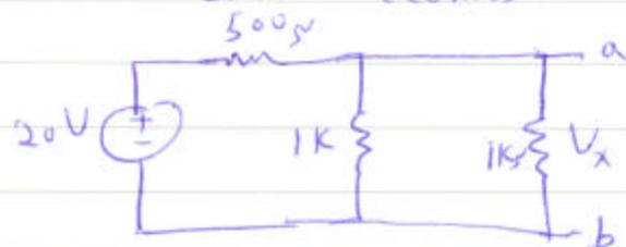
$$V_{th} = V_x = 20V \times \frac{1k\Omega // 1k\Omega}{1k\Omega // 1k\Omega + 500}$$
